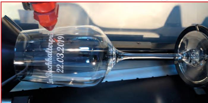
Wir gravieren Glas, Keramik, Metall, Kunststoff und Holz. Die Möglichkeiten unseres Angebotes im Bereich Gravur sind schier unendlich. Welche Materialien können graviert werden? Zum Beispiel beschichtete oder blanke Metalle, unbehandelte, beschichtete oder durchgefärbte Kunststoffe, Keramik, Holz, Acryl, Glas und viele mehr auf Anfrage. Durch die Rotations-einrichtung können auch zylindrische Körper, wie Gläser oder Flaschen graviert werden.
